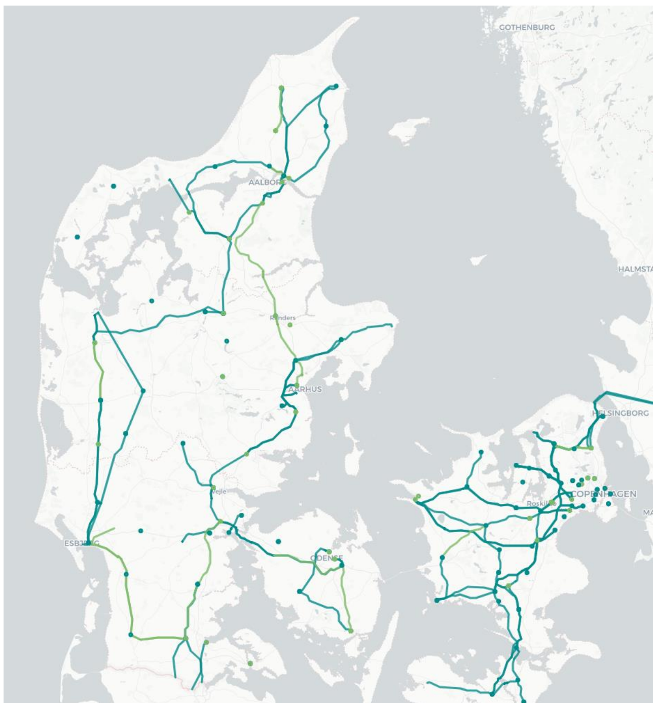
Figur 11 Nødvendige reinvesteringer i det danske eltransmissionsnet på grund af opbrugt levetid. Linjer og komponenter markeret med blå skal reinvesteres inden 2025. Linjer og komponenter markeret med grønt skal reinvesteres inden 2030.
